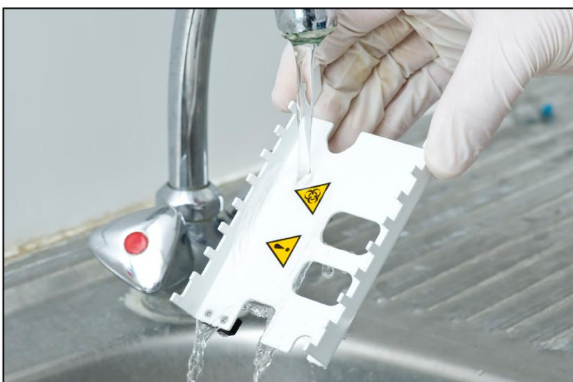
Figura 54: Risciacquo della rastrelliera di avanzamento delle strisce
