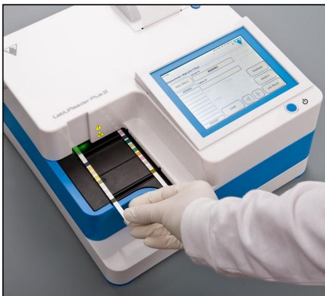
**4** Quando si accende una luce verde continua nell'area di inserimento delle strisce, posizionare la striscia reattiva nella vaschetta delle strisce reattive, all'interno della area di inserimento delle strisce, con i pad rivolti verso l'alto.
