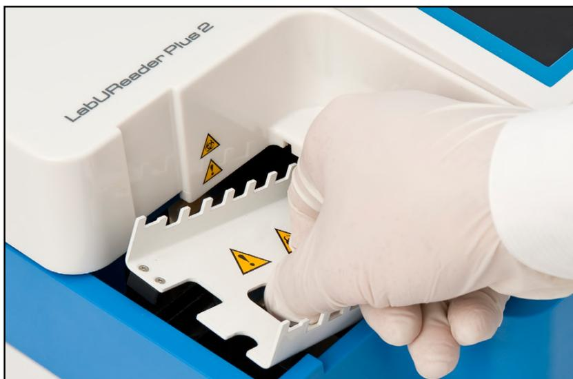
Figura 9: **Inserimento della rastrelliera di avanzamento delle strisce**
