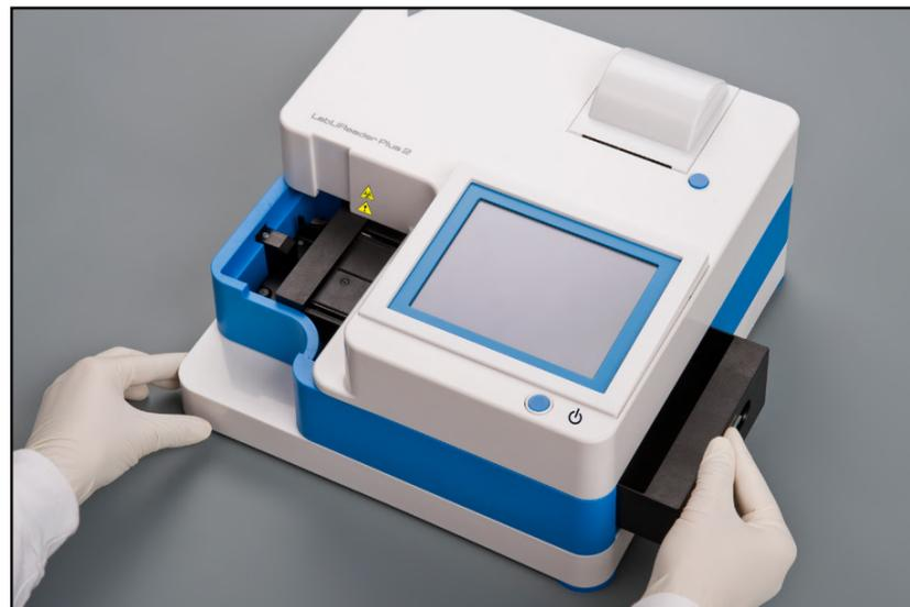
Figura 10: **Inserimento della vaschetta delle strisce reattive**
